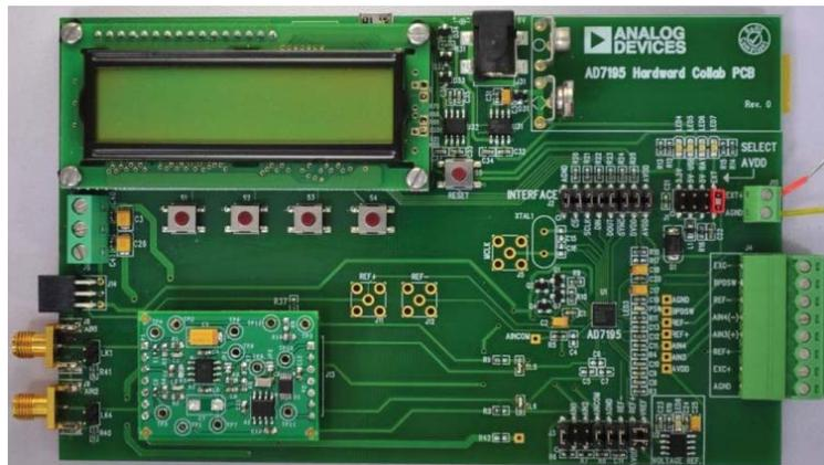
図 4. ノイズ評価のセットアップ
