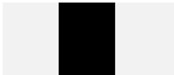
図 4. ADA4830-1 によって 1Vp-p、500kHz のコモン・モード・ノイズを除去した、黒いストライプのビデオ表示画面
