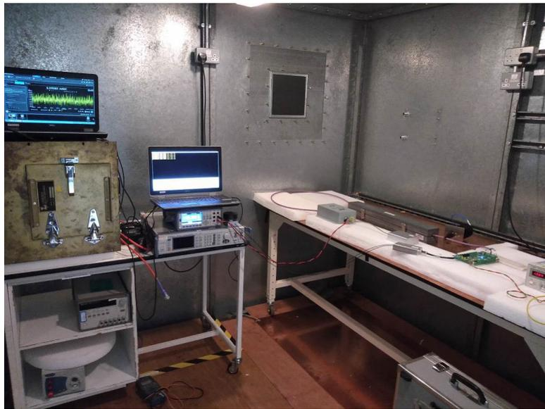
図 10. IEC 61000-4-6 試験用セットアップの写真
