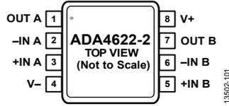
図 4.8 ピン MSOP ピン配置、ADA4622-2
