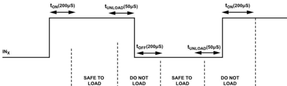
図 5. スイッチ負荷プロファイル
