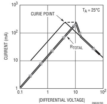
図 3. PTC 特性曲線上に  $R_{TOTAL}$  を重ねた図
