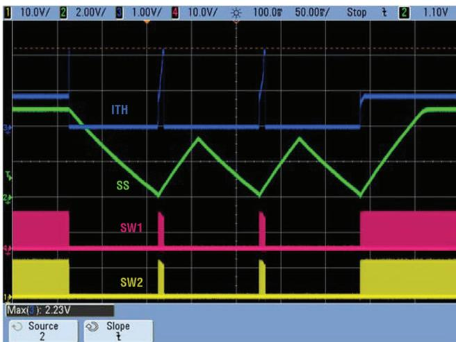
図4. ヒカップ・モードの過電流保護と回復動作
