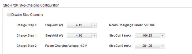
図3. ステップ充電を有効にするための構成
