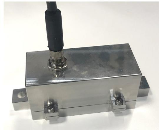
図1 10BASE-T1Lシングルペア・イーサネットによる状態監視 (振動) センサーのプロトタイプ。
