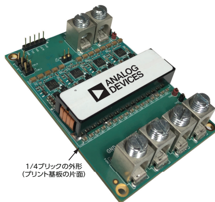
図5. 48Vから12Vへの降圧を担うレギュレータ。すべてのコンポーネントは、基板上面（1/4ブリックの外形範囲内）に配置されています。約1mmのコンポーネントをすべて背面に配置すれば、1/8ブリック・サイズに収めることができます。
