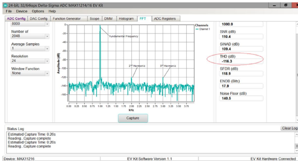
図 3. MAX11216 の出力の FFT 結果 (その 3)。THD の値は 116.3dB となっています。 サンプル・レートが 8ksps、 f_{IN} = 1\text{kHz} 、 V_{AVDD} = 3.6\text{V} 、 V_{AVSS} = 0\text{V} 、 V_{REF} = 3.6\text{V} 、 T_A = 25^\circ\text{C} 、 外部クロックの周波数が 8.192MHz という条件で取得しました。
