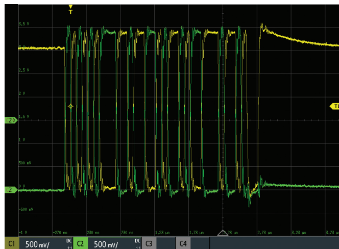
図6 実験装置を使ってキャプチャしたUSB信号
