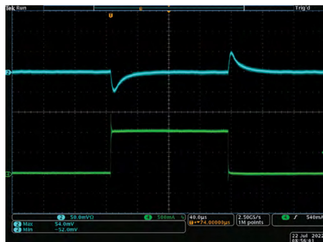
図8 VCC_3V3レールの負荷過渡応答
