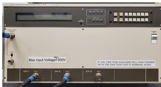
図6. 測定に使用した年代物のネットワーク・アナライザ (Venable Instrumentsの「5060A」)。ハイサイドへのフローティング・ノイズの注入と測定に使用しました。
