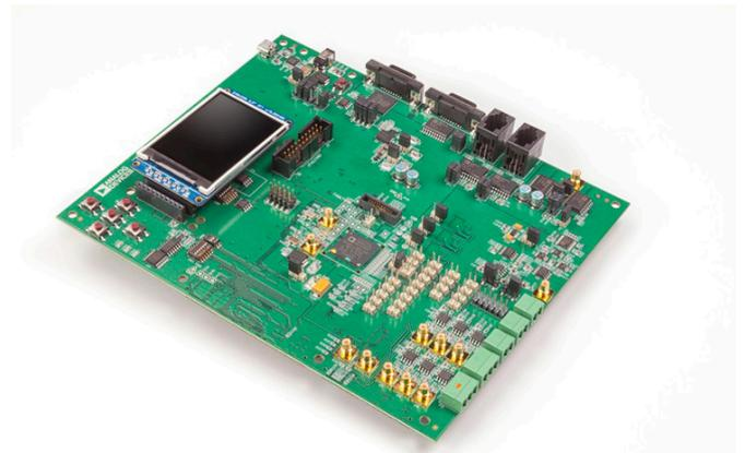
図8. ADSP-CM419Fの評価用ボード
