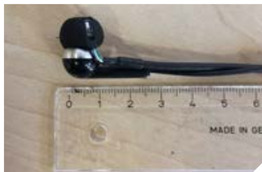
図1. 光学センサーおよび加速度センサーを組み込んだシステムと、比較用のスケール。
