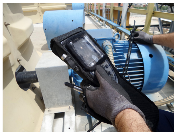
図1 圧電センサーとハンドヘルド・ロガーを使用した、手作業による装置の検査
