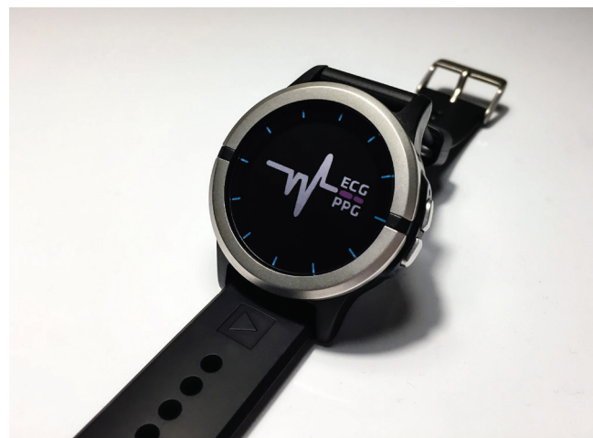
図1. アナログ・デバイセズが開発した腕時計型の開発プラットフォーム。VSMの研究に使用されます。
