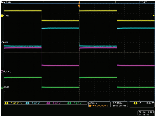
図2. CANのプロトコルにおける物理層の信号
