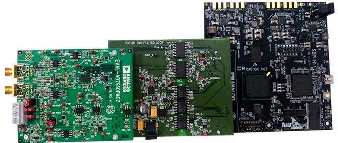
図4. AD7960およびSDP-H1用のADN4651絶縁回路
