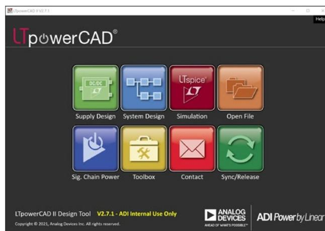
図13. 電源回路の設計を効率化するLTpowerCADのトップ画面。入出力仕様に該当する電源ソリューション(IC)の検索機能や、リファレンス回路から静的な特性を確認する機能などを備える。また、電源ツリーの設計ツールLTpowerPlannerや、シミュレーション・ツールLTspiceとも連携している。
